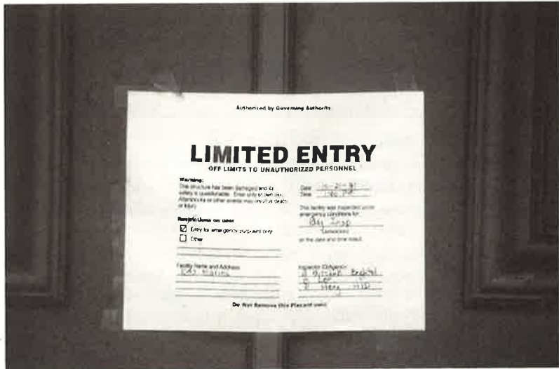
Bild 66, Anschlag an der Haustüre eines Gebäudes, welches nach der Schadenbeurteilung nur noch beschränkt genutzt werden durfte (limited entry)
