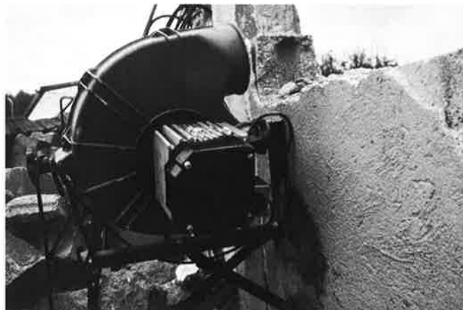
Bild 2. Erdbeben in Süditalien vom 23.11.1980: Ventilator in eingestürztem Fabrikgebäude [1]
