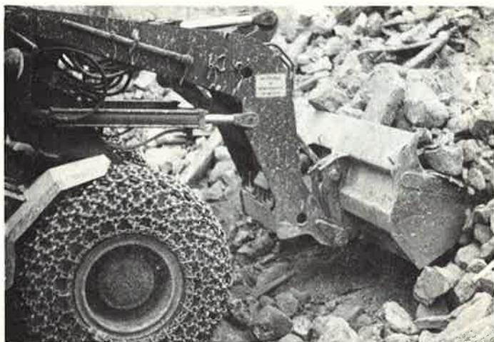
Pneurlader mit Reifenschutzketten ausgerüstet
