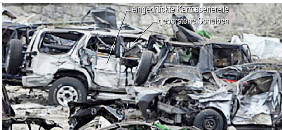
14: Typische durch die Druckwirkung an Fahrzeugen entstandene Schäden (eingedrückte Karosserie, zerbrochen Scheiben)
