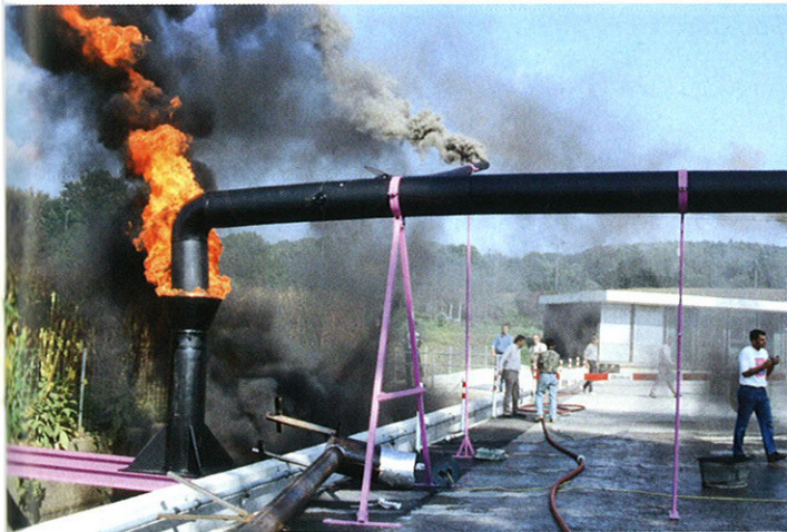
1: Versuche zum Brandverhalten in Brückenentwässerungssystemen.
