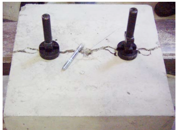
Bild 8 Mit dynamischen Lasten und in gerissenem Beton durchgeführte Tests geben Aufschluss über die Eignung von Metalldübeln für erdbebensichere Befestigungen
