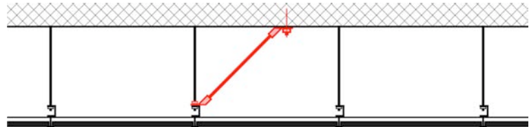
Bild 5 Erdbebensicherung von abgehängten Decken nach [3]
