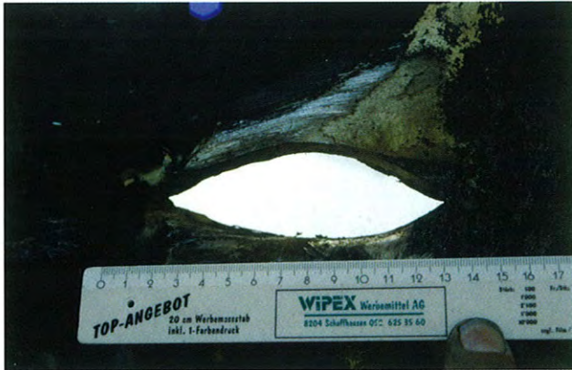
3: Eine von mehreren Perforationen in einem Transporttank nach einem Kippen des Fahrzeugs auf eine niedere Leitschranke.
