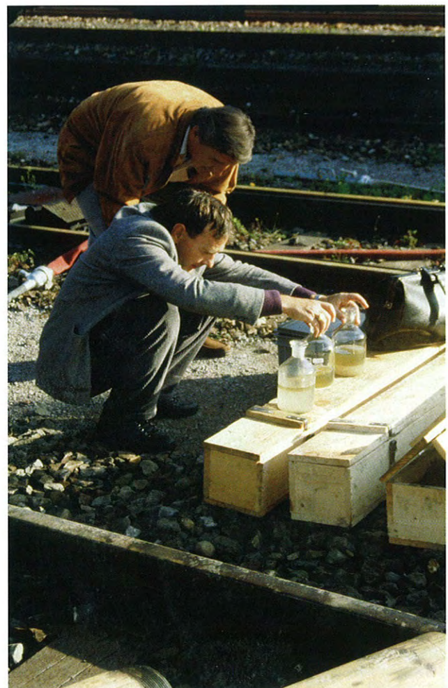
5: Aus einem Bohrloch in kiesig-sandigem Untergrund entnommene Proben eines Gemischs von Wasser und Benzin.
