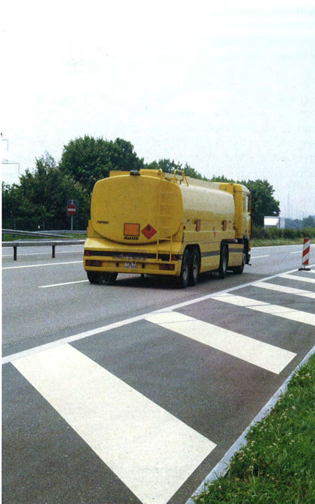
2: Tanklastfahrzeug mit tiefem Schwerpunkt.
