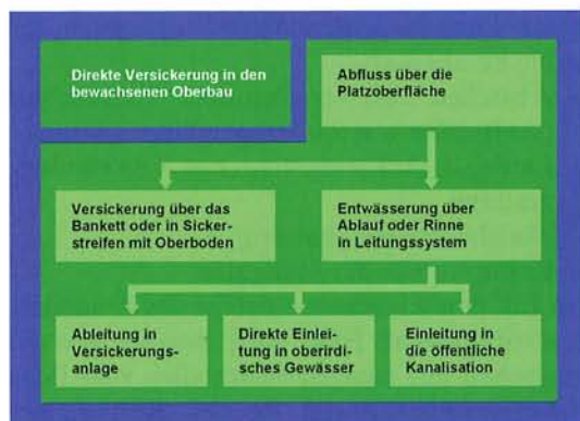
Abb. 1 Übersicht über die Entwässerungssysteme.
