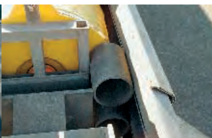
9: Anneau d'absorption à l'extrémité postérieure d'un amortisseur de choc.
