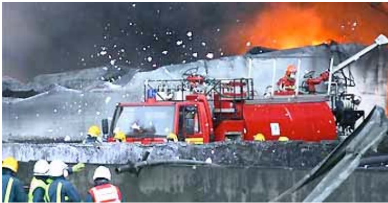
Löschfahrzeug mit Schaumwerfer im Einsatz
