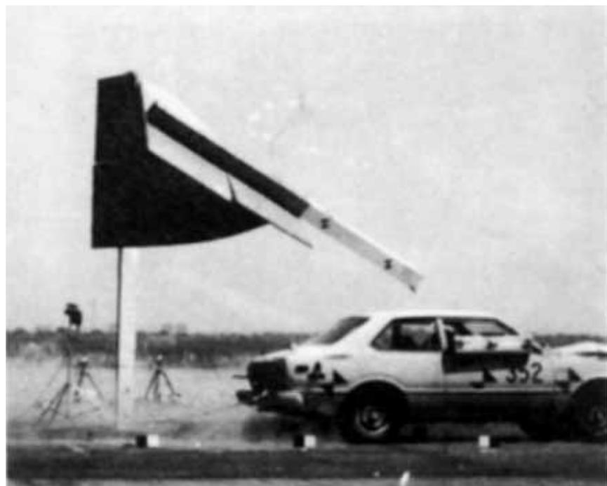
8: Signalständer gemäss Abb. 7 beim Anpralltest mit PW, 1075 kg, 92 km/h [7].
